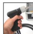
Pompe à smoke automatique intégrée dans la poignée de la sonde de prélèvement
