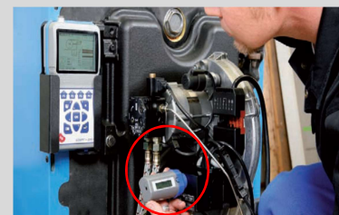
L'écran de l' ECOM J2KN pro affiche les données relevées par l' ECOM-AK.
