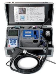
Jusqu'à 6 capteurs électrochimiques
