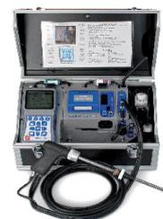
Jusqu'à 6 capteurs électrochimiques
